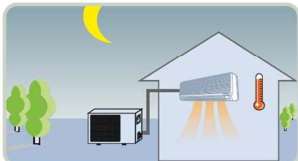
При включении режима обогрева вентилятор внутреннего блока устанавливается на минимальную скорость, чтобы избежать чрезмерного поступления холодного воздуха в помещение. Когда температура теплообменника поднимается выше 28°C, вентилятор начинает работать на установленной скорости.
