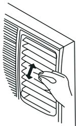
Положение горизонтальных направляющих нужно изменять, когда кондиционер включен. Чтобы направить поток воздуха вверх или вниз, поверните одну из горизонтальных направляющих (см. рисунок). Если Вы направляете воздушный поток вверх или вниз, то верхняя или нижняя направляющие всегда должны оставаться горизонтальными. Это предотвратит капание конденсата с передней панели кондиционера.
