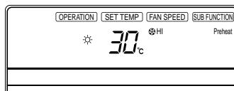
**6** Если температура на улице слишком низкая, кондиционер автоматически переходит в режим интенсивного обогрева, при этом на пульте дистанционного управления отображается "DEFROST".
