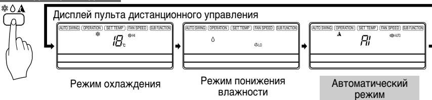
3 Температура и скорость вращения вентилятора устанавливаются автоматически в соответствии с температурой воздуха в помещении. Если температуру требуется изменить, закройте крышку пульта дистанционного холоднее (или, наоборот, жарче), тем большее количество раз нужно нажать на кнопку (не более двух раз). Установленная температура воздуха изменится.
