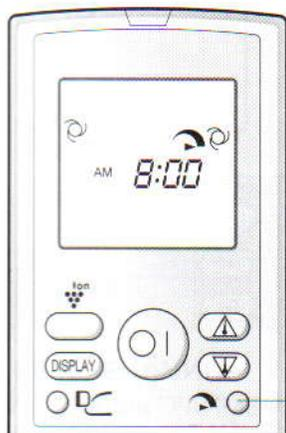
**1** Чтобы включить режим работы на ПОЛНУЮ МОЩНОСТЬ, нажмите кнопку ПОЛНОЙ МОЩНОСТИ во время работы аппарата.
