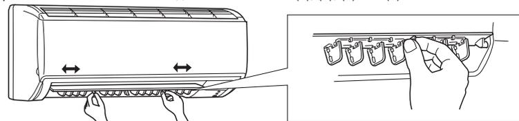
Отрегулируйте вертикальную заслонку, передвигая фиксатор в направлении, противоположном предпочтительному направлению воздушного потока.
