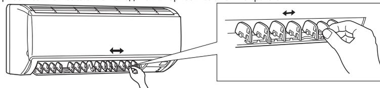
Отрегулируйте вертикальную заслонку, передвигая фиксаторы второй заслонки с обоих концов вертикальной заслонки в сторону предпочтительного направления воздушного потока.
